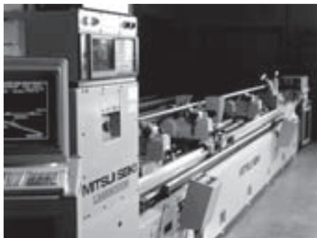
Лазерная автоматическая установка для измерения шага резьбы
