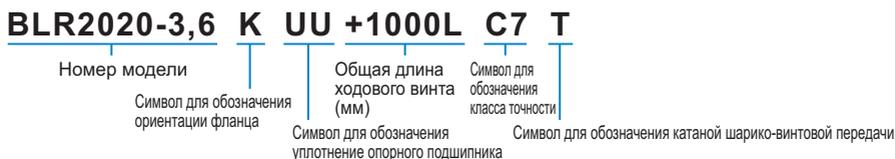
Примечание) Зазор в осевом направлении см. на **A15-27**.
