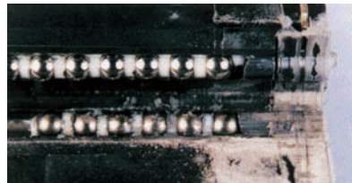
№ 1 прошел 100 км (исполнение с двойным уплотнением)
